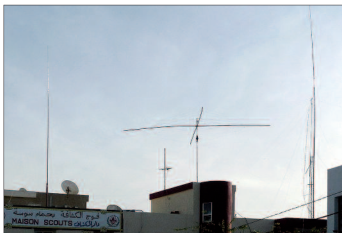
3V8SS mit den neuen Antennen: 40-m-Groundplane, Spiderbeam und eine Vertikalantenne für die Bänder 80 m und 160 m
