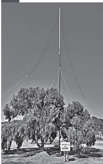
3V8SFの1.8MHz用12m高 バーチカル・アンテナ
